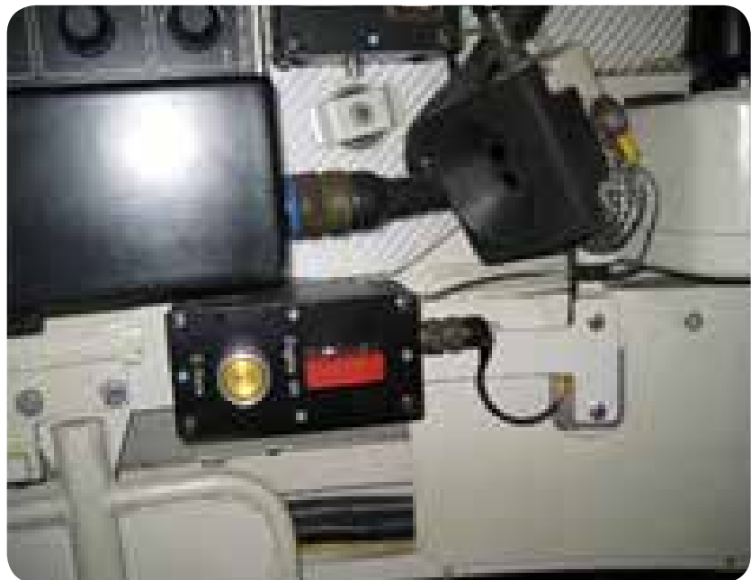
Fig.9 - Colocação de um dispositivo de corte do motor na torre do carro de combate.
