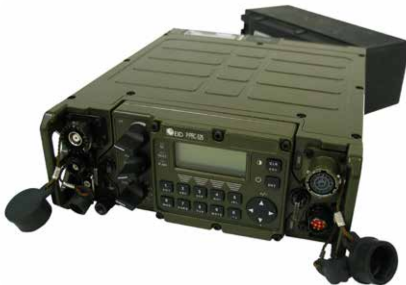
Fig.4 - O Rádio Multifuncional GRC-525 é um equipamento rádio tático usado nas redes rádio de combate nas configurações de manpack, veicular ou fixo. Equipamento rádio multibanda (HF/VHF/UHF) e multimodo (voz e dados), que permite comunicações seguras.
