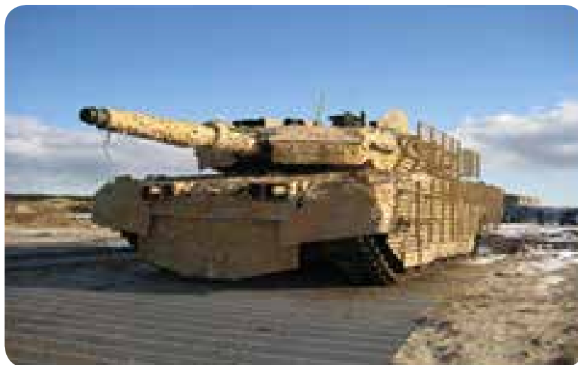
Fig.6 - Sistema de camuflagem BARRACUDA e Slat Cages.
