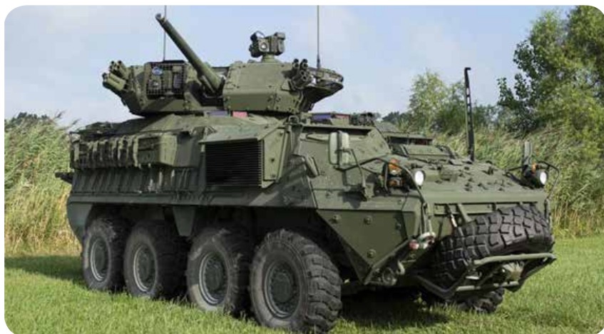
Fig. 6 - A viatura Stryker com um canhão de 30 mm.
