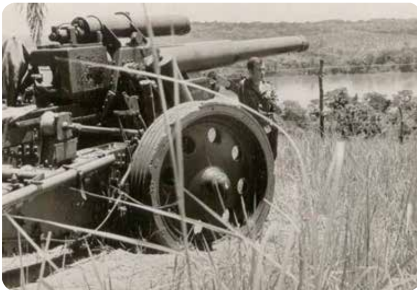
Fig.4 - Obus 15 cm Krupp m/1941 junto ao rio Cuango em Angola.
