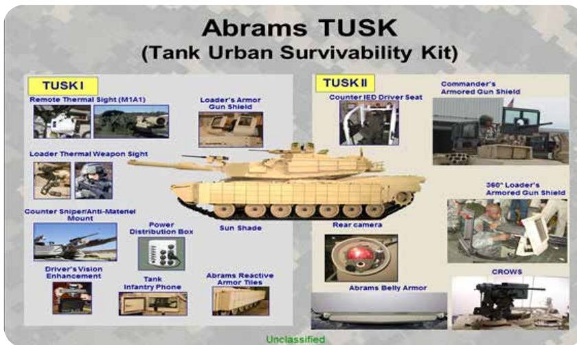
Fig.5 - Principais alterações efetuadas pela força de Marines ao seu Abrams M1.
