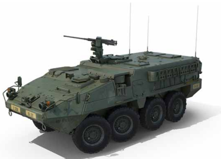
Fig.4 - Versão base da viatura Stryker armada com metralhadora pesada 0.50 cal..
