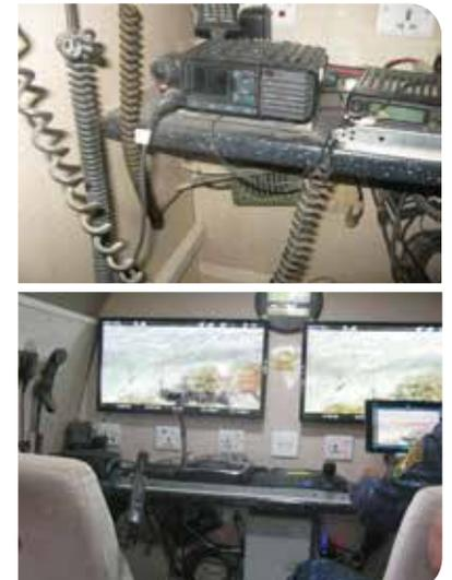
Fig. 4 – Viatura de comunicações (à esq.) equipada com duas estações rádio *Hytera* e *ICOM* (em cima) e um operador a controlar um UAV (em baixo).
