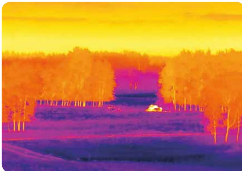
Fig. 3 - Diferença da facilidade de deteção térmica entre dois CC Leopard 2, um equipado com o SAAB Barracuda - MCS e outro sem
