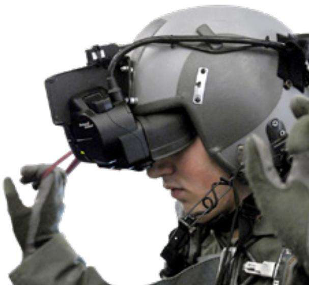
Figura 03: Sistema de treino queda livre - PARASIM.
