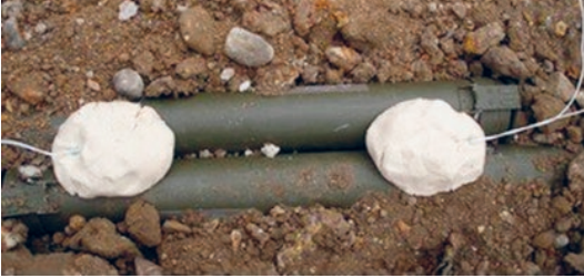
Fig. 14 - Aplicação do Explosivo PE-4A na destruição de MEAF
