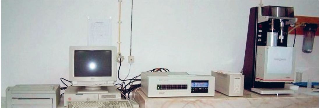
Fig. 7 - Equipamento para análise térmica de materiais energéticos, com capacidade para várias rampas de aquecimento até 1500°C, sob diferentes atmosferas
