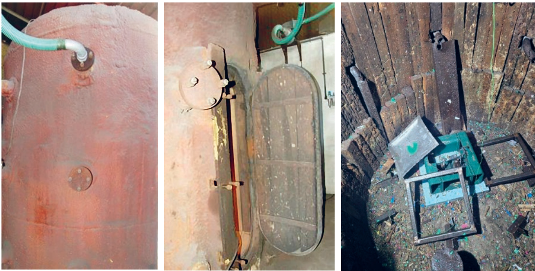
Fig. 3 – Três perspectivas da câmara de ensaios de detonação até 1 kg eq. TNT
