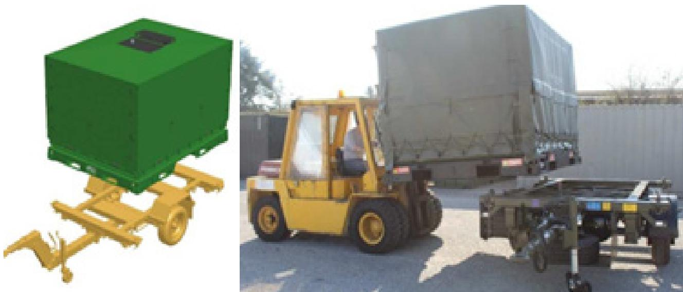
**Figura 03:** Exemplo de cozinha com módulos amovíveis à estrutura do chassi do atrelado. **Fonte:** EME, 2019.
