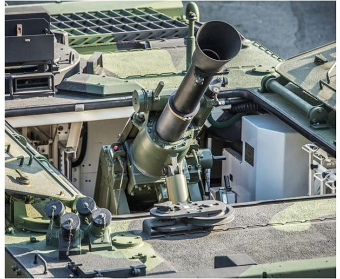
**Figura 05:** Morteiro automático montado em viatura PANDUR. **Fonte:** <https://www.forumdefesa.com/forum/index.php?topic=12692.30>
